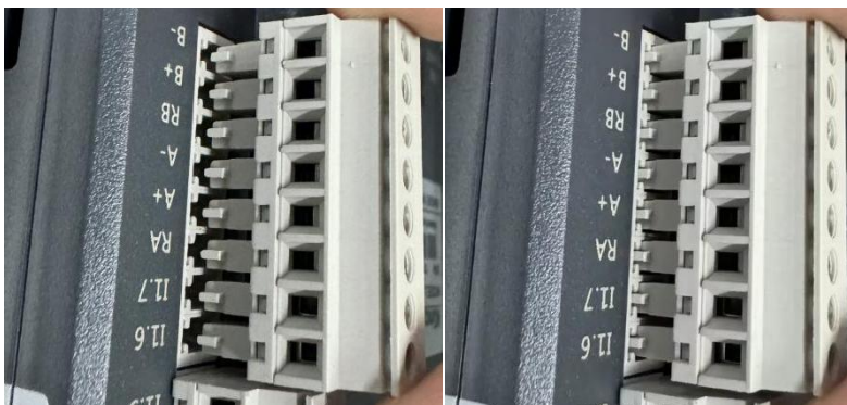
图 3.3-3: 端子安装步骤示意 1
