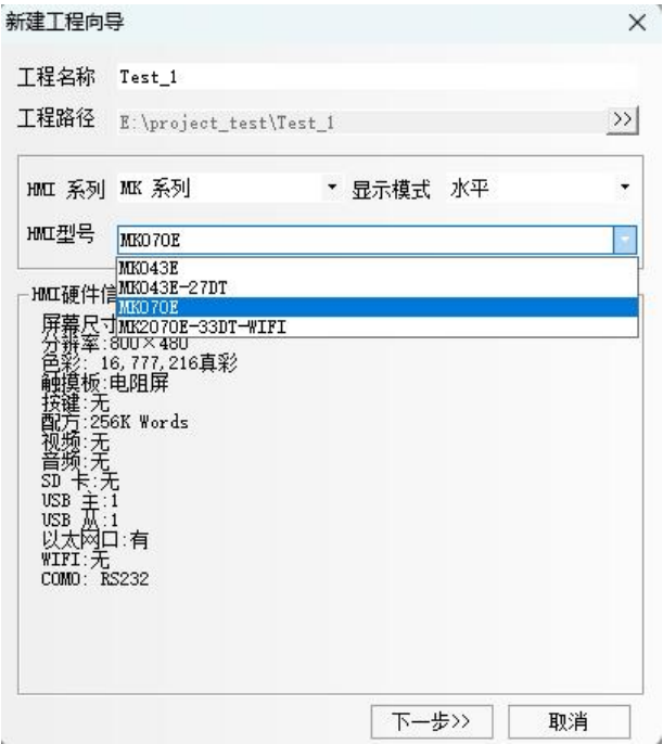
图 5.1-9 选择 HMI 型号，这里以 MK070E 为例 设置好后点击[下一步>>]按键，完成工程创建。
