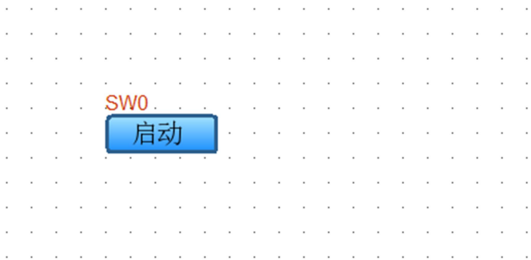
图 5.4-9 成功创建位状态切换开关
