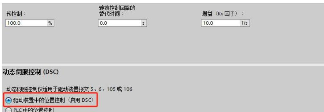
20. 工艺对象组态完毕，点击左侧 PLC\_1 下拉列表中的“程序块→MC-Servo[OB91]”，右键打开属性，可设置 PLC 的应用周期。请注意，使用 DSC 功能时，组态的 PLC 应用周期、伺服更新周期(见第 8 步)、ECAN 同步周期[301101]三者必须相同。
