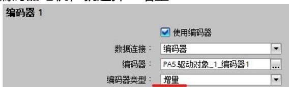
如果使用步科多圈绝对值编码器电机，就选择“循环绝对值编码器”：
