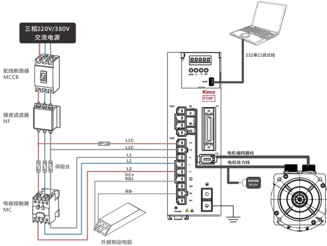
图 3-7 FD435P, FD445P(三相 220V)/FD615P,FD625P(三相 380V) 供电外部接线图
