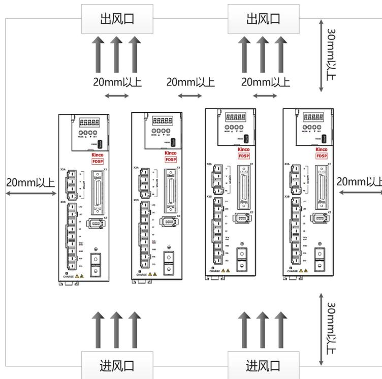
图 2-2 FD435P/FD445P/FD615P/FD625P 安装方向及要求
