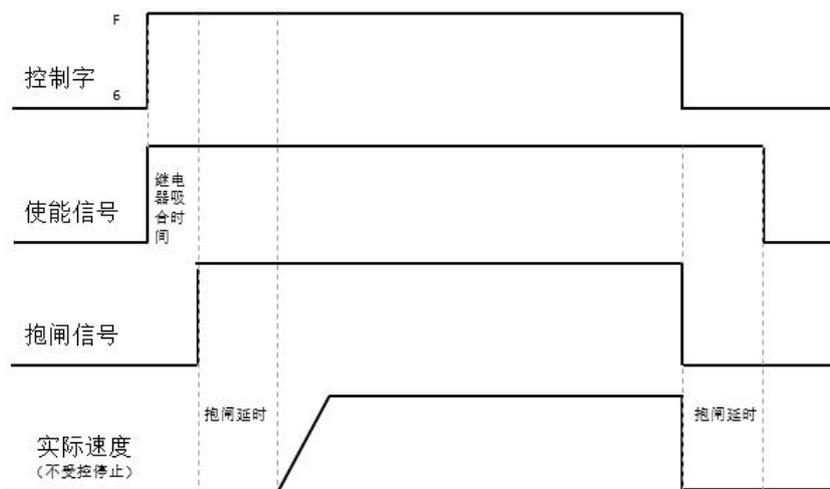
图 6-16 快速停止模式为 0 时电机抱闸时序
