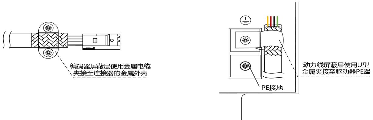
图 3-16 驱动器侧动力线/编码器线屏蔽层 1\*处理方式
