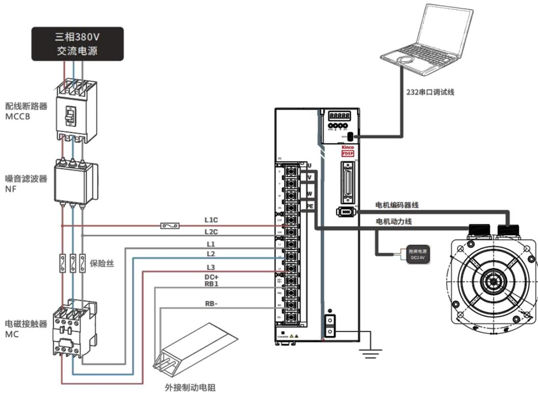
图 3-8 FD635P/FD645P 三相 380V 供电外部接线图
