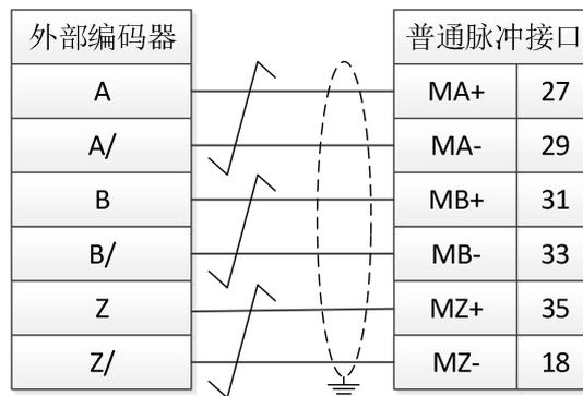
图 6-11 全闭环控制连接普通脉冲接口
