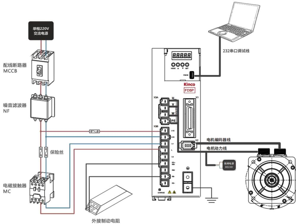
图 3-6 FD435P/FD445P 单相 220V 供电外部接线图
