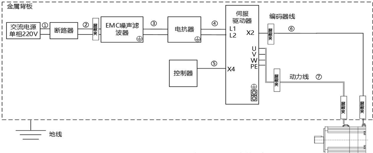
图 3-12 FD415P/425P 驱动器 EMC 设置条件示意图
