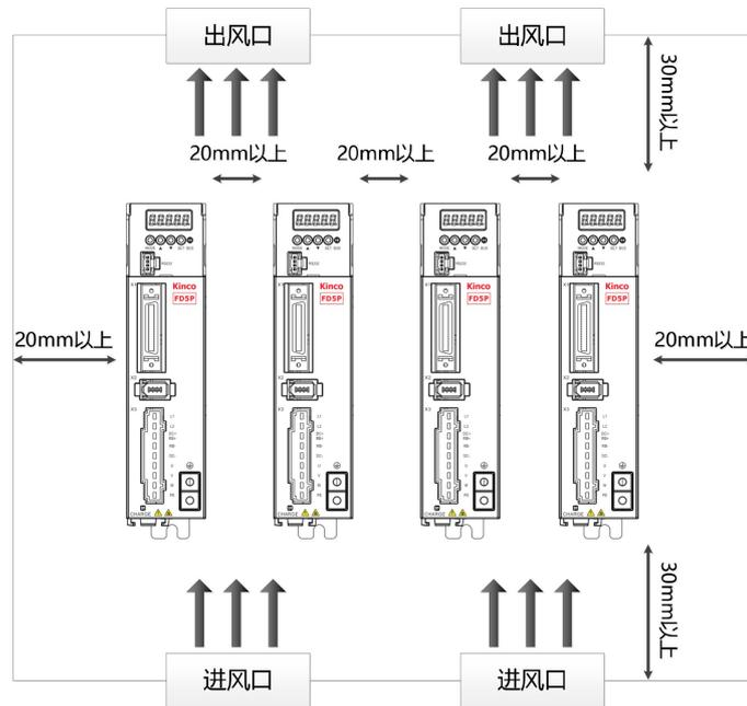
图 2-1 FD415P/FD425P 安装方向及要求
