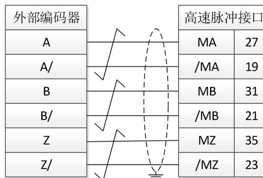
图 6-12 全闭环控制连接高速脉冲接口
