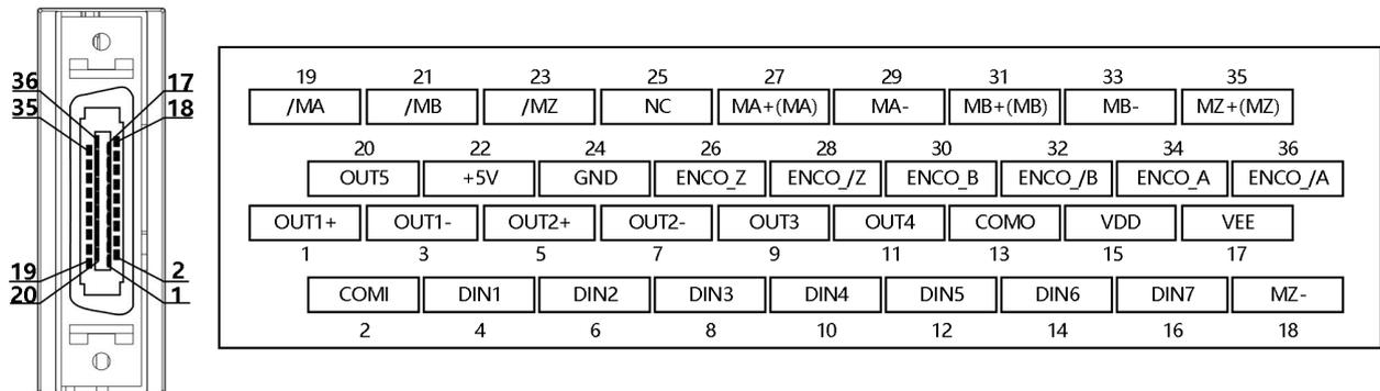
图 3-9 FDxx5P-LA/CA/EA 驱动器外部输入输出端子引脚示意
