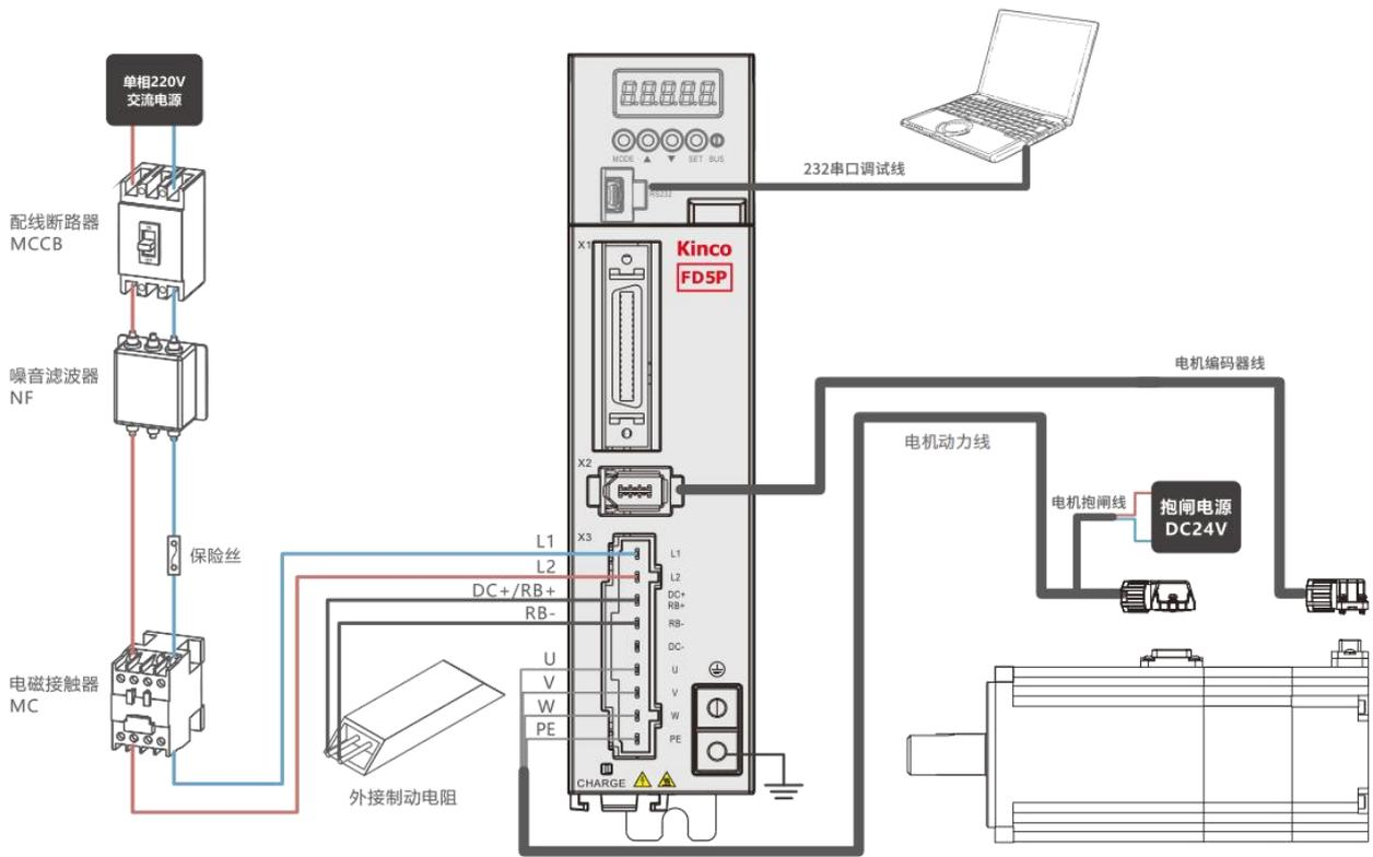
图 3-5 FD415P/FD425P 外部接线图
