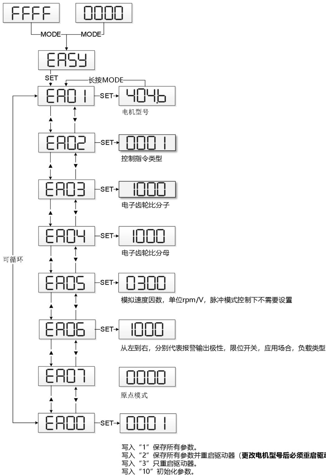
图 4-3 EASY 操作流程
