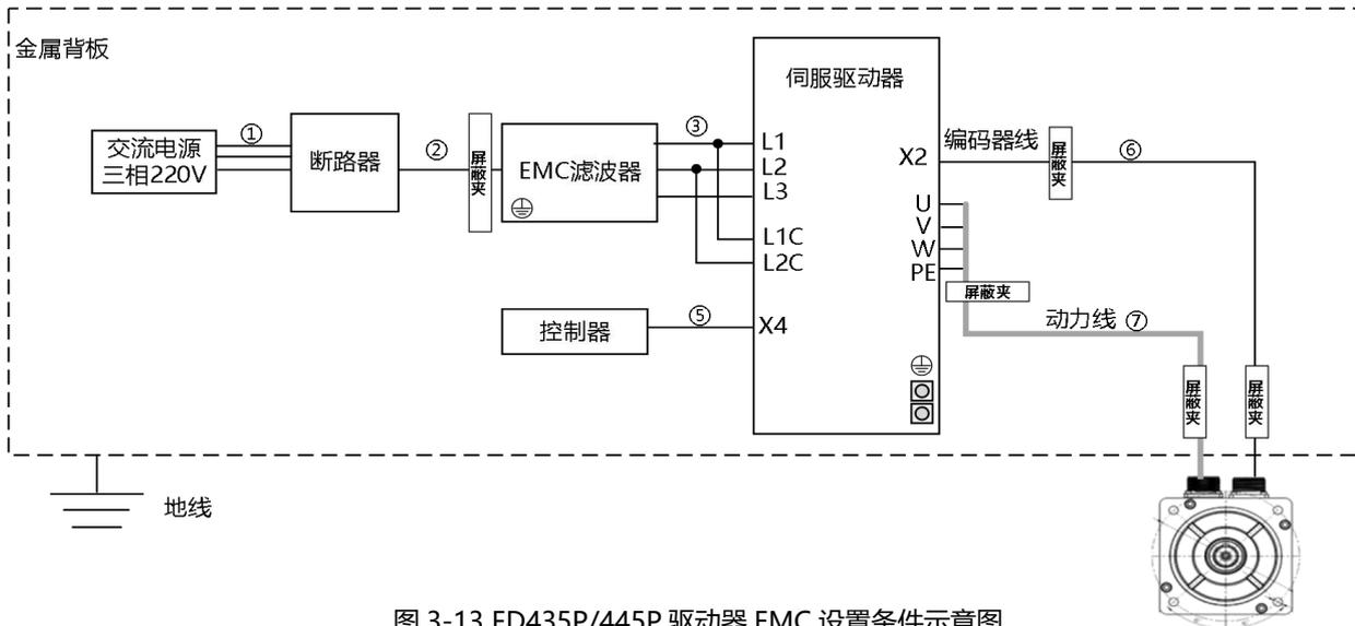
图 3-13 FD435P/445P 驱动器 EMC 设置条件示意图
