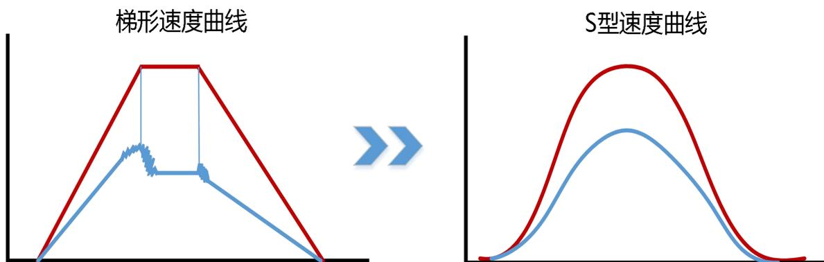
图 7-7 S 型速度阶跃曲线
