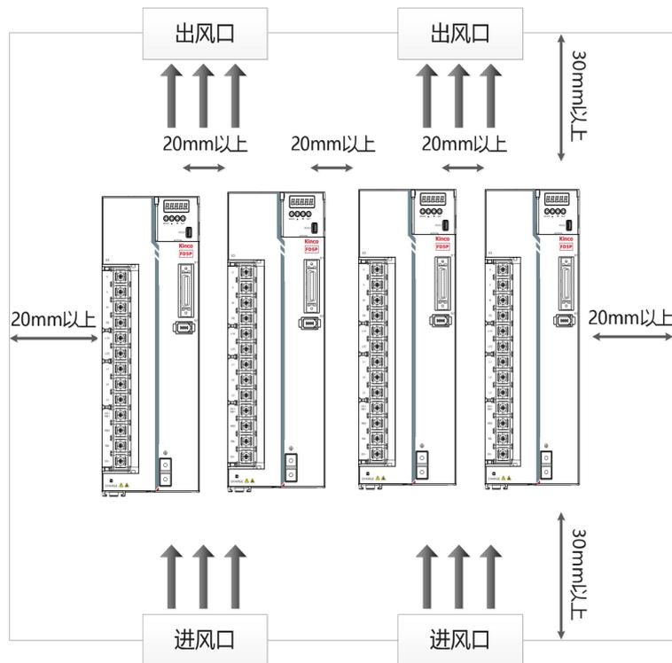
图 2-3 FD635P/FD645P 安装方向及要求
