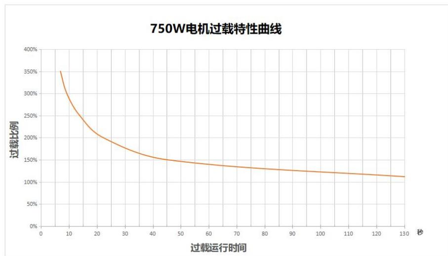
图 3-19 750W 电机过载特性曲线
