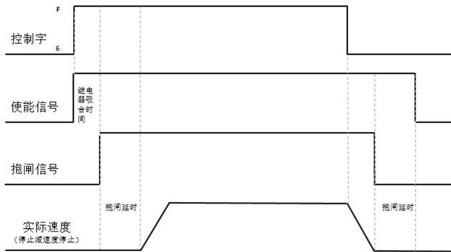
图 6-17 快速停止模式为 2 时电机抱闸时序
