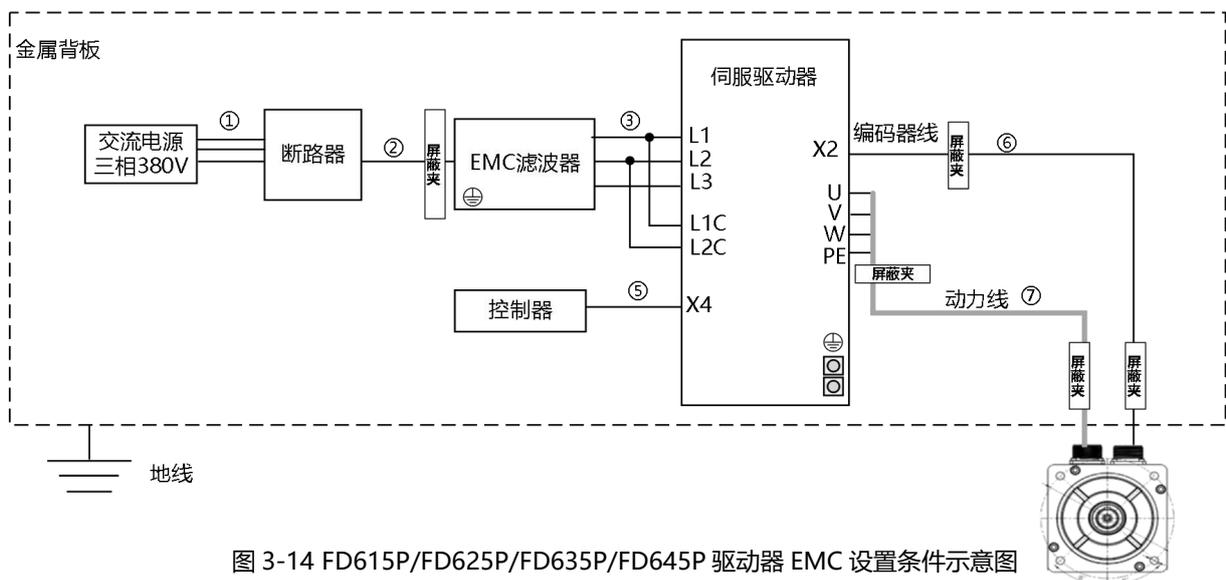
图 3-14 FD615P/FD625P/FD635P/FD645P 驱动器 EMC 设置条件示意图
