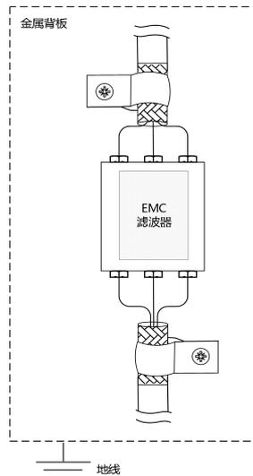
图 3-15 EMC 噪音滤波器安装示意图
