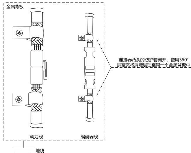
图 3-17 连接器侧动力线/编码器线屏蔽层 2\*处理方式
