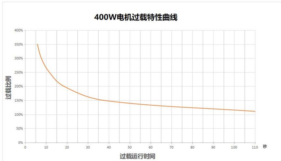
图 3-18 400W 电机过载特性曲线
