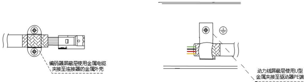
图 3-9 FD1X5 驱动器侧动力线/编码器线屏蔽层 1*处理方式
